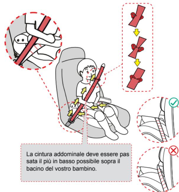
NOTA 2: La sezione diagonale della cintura deve essere rivolta verso la parte posteriore. Potete regolare la direzione della cintura con il rullo.
