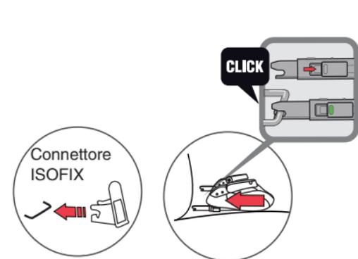
Passo 3: Rimuovere la cintura di sicurezza. Far passare la sezione ventrale attraverso la guida ②, poi far passare la sezione diagonale e ventrale attraverso l'altro lato della guida ②. (NOTA: La sezione diagonale deve passare sopra il bracciolo, la sezione ventrale - sotto il bracciolo). Spingere i connettori direttamente negli ancoraggi fino a quando non si sente un clic.
