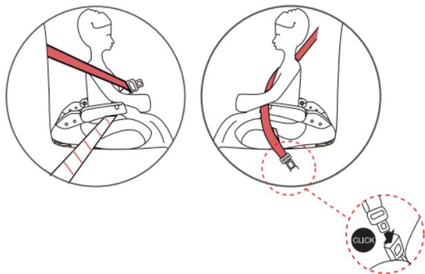
Passo 4: Assicuratevi che la sezione diagonale della cintura di sicurezza stia sopra l'osso della spalla del bambino, e non davanti al suo collo (tra il punto A e il punto B nella figura 2)
